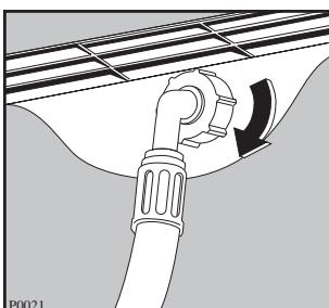
Другой конец наливного шланга, подключающийся к машине, может быть повернут в любом направлении. Ослабьте гайку, поверните шланг и вновь затяните гайку, проверив отсутствие течи воды. Наливной шланг нельзя вытягивать. Если он слишком короткий, и вы не хотите передвигать кран, то вам следует купить новый, более длинный шланг, специально предназначенный для данных целей.
